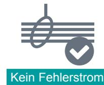
Die Differenzstromüberwachung berechnet und überwacht die Fehlerströme in geerdeten Niederspannungsnetzen. Die Berechnung erfolgt als vektorielle Summe aller aktiven Leiter. Fehlerströme treten typischerweise aufgrund von Leckströmen oder Isolationsfehlern auf, die meist die Folge mechanischer Defekte, fehlerhafter Komponenten usw. sind.
